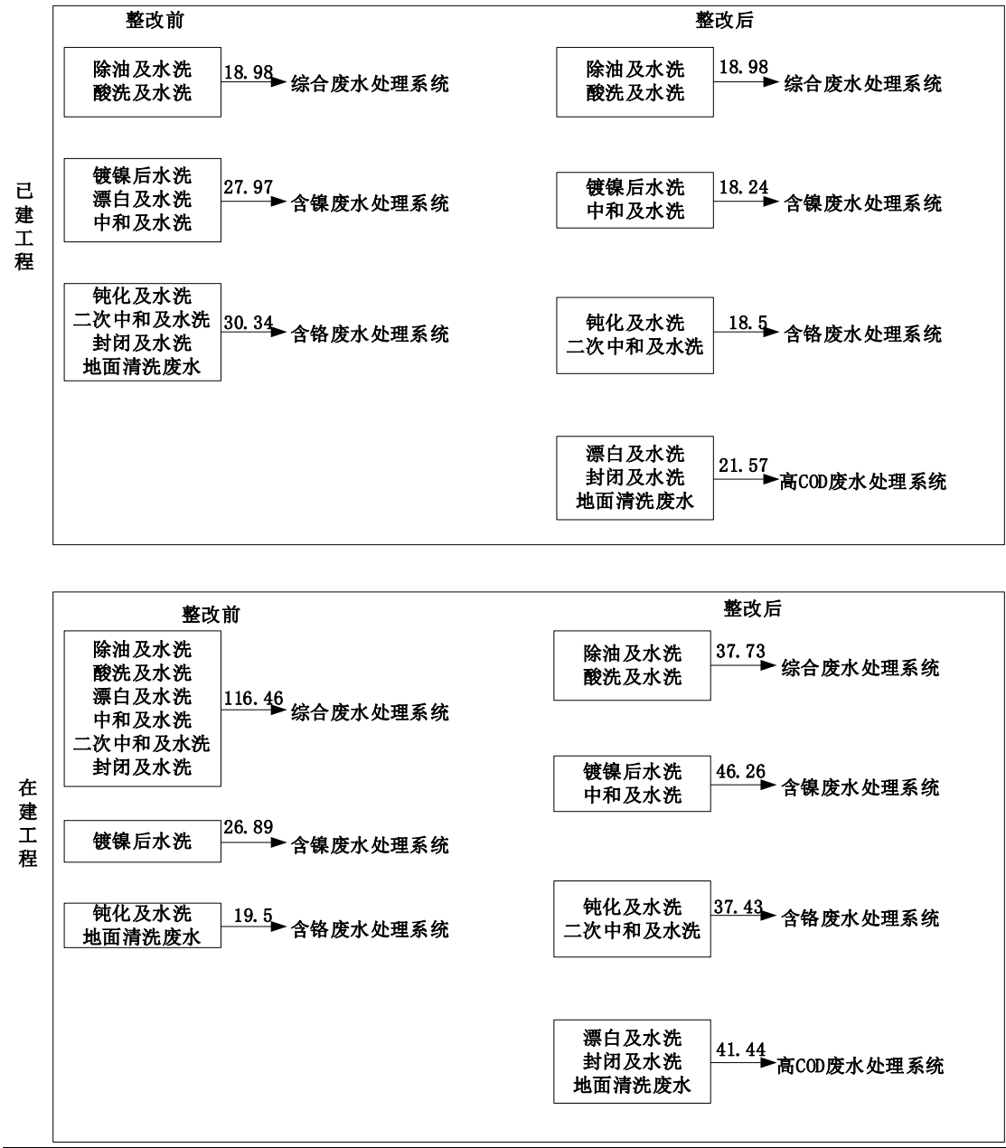
图 3-33 现有工程“以新带老”整改后，各废水处理去向图
